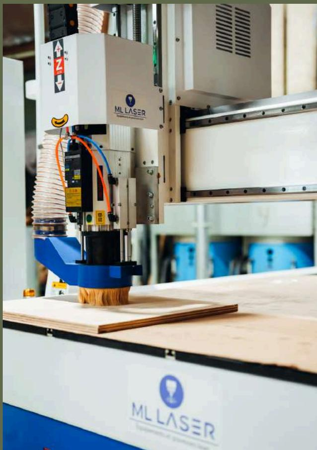
Notre atelier d'usinage est équipé d'une machine CNC, avec sa table grand format d'une capacité utile de 3m20 par 1m60.
